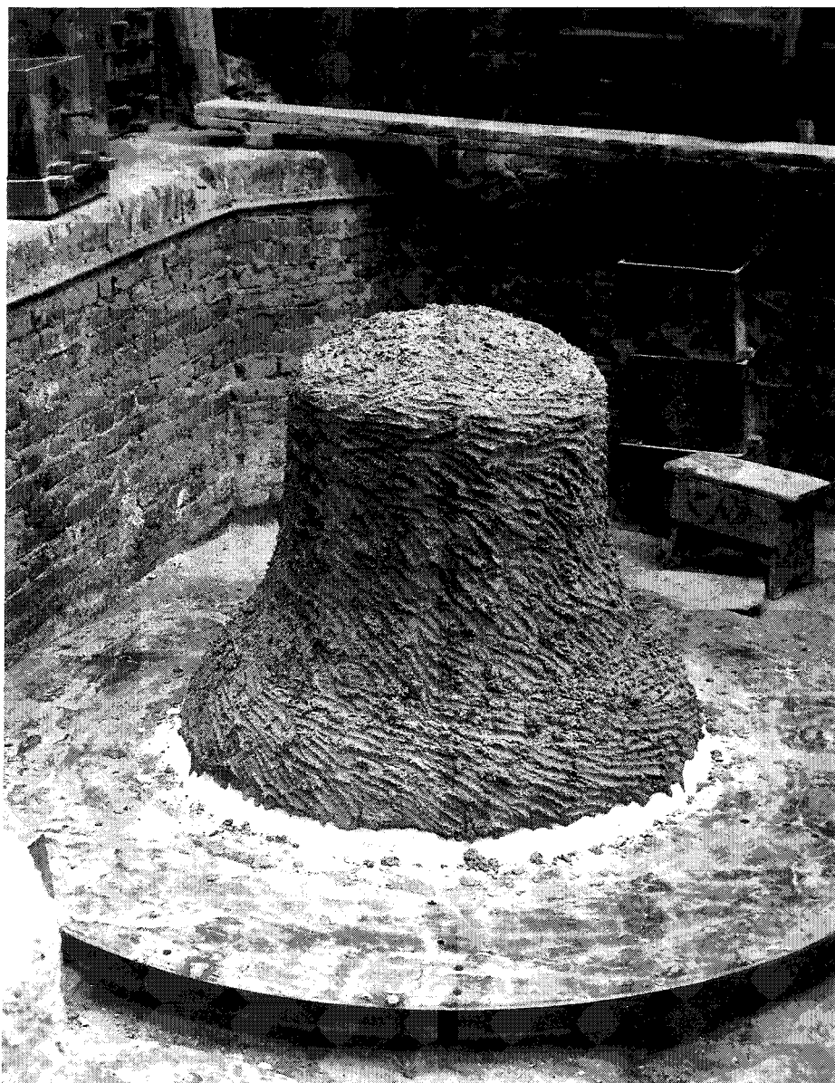
Afb. 343: Over de valse klok is een laag chamotte meel aangebracht waarin zich de valse klok afdrukt zodat een negatief van de buitenkant van de te gieten klok verkregen wordt (foto Eijsbouts Asten)
