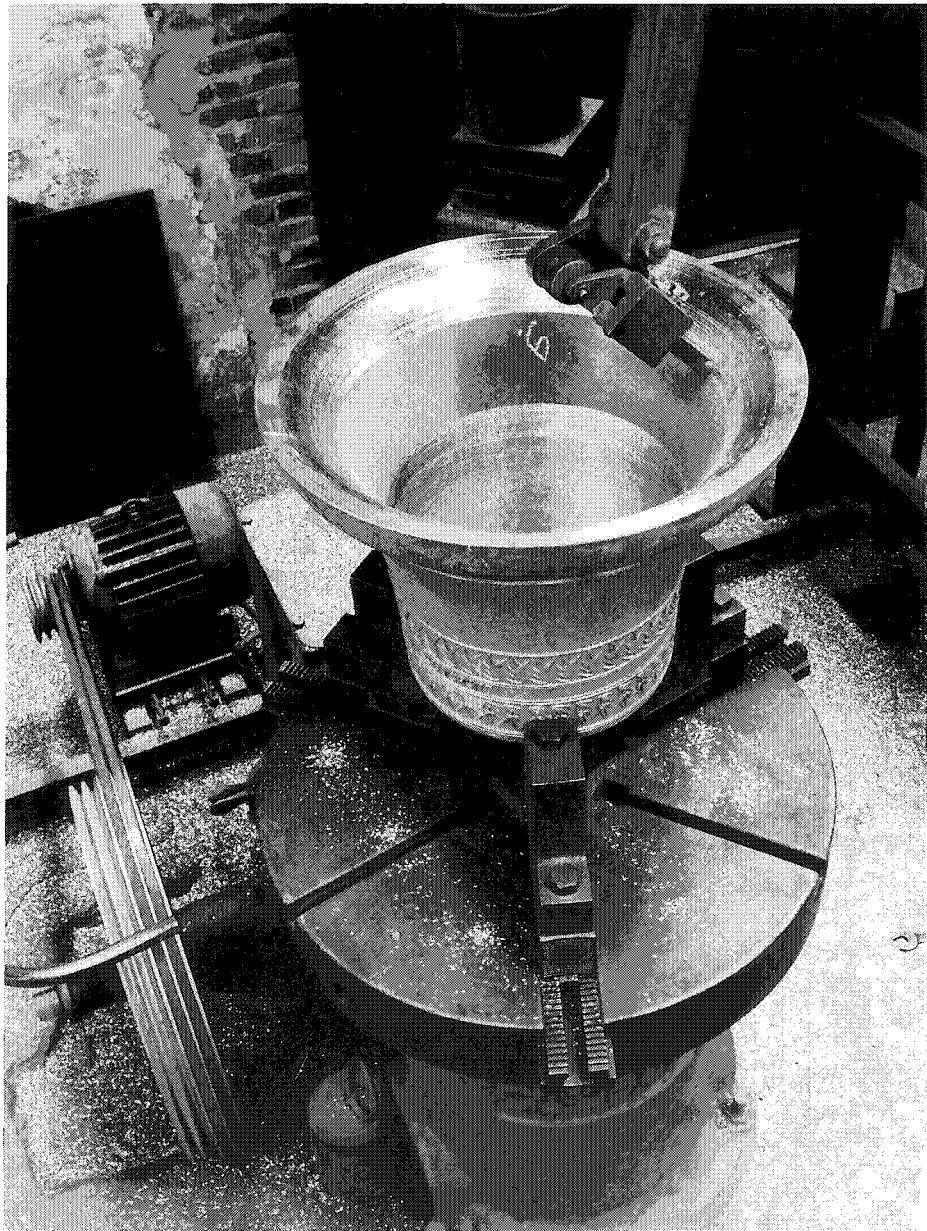
Afb. 355: De klok wordt gestemd door op bepaalde plaatsen aan de binnenkant brons weg te draaien op de carrousel draaibank, waardoor wordt bereikt dat de grondtoon en de boventonen een muzikaal akkoord met elkaar zullen vormen (foto Eijsbouts Asten)
