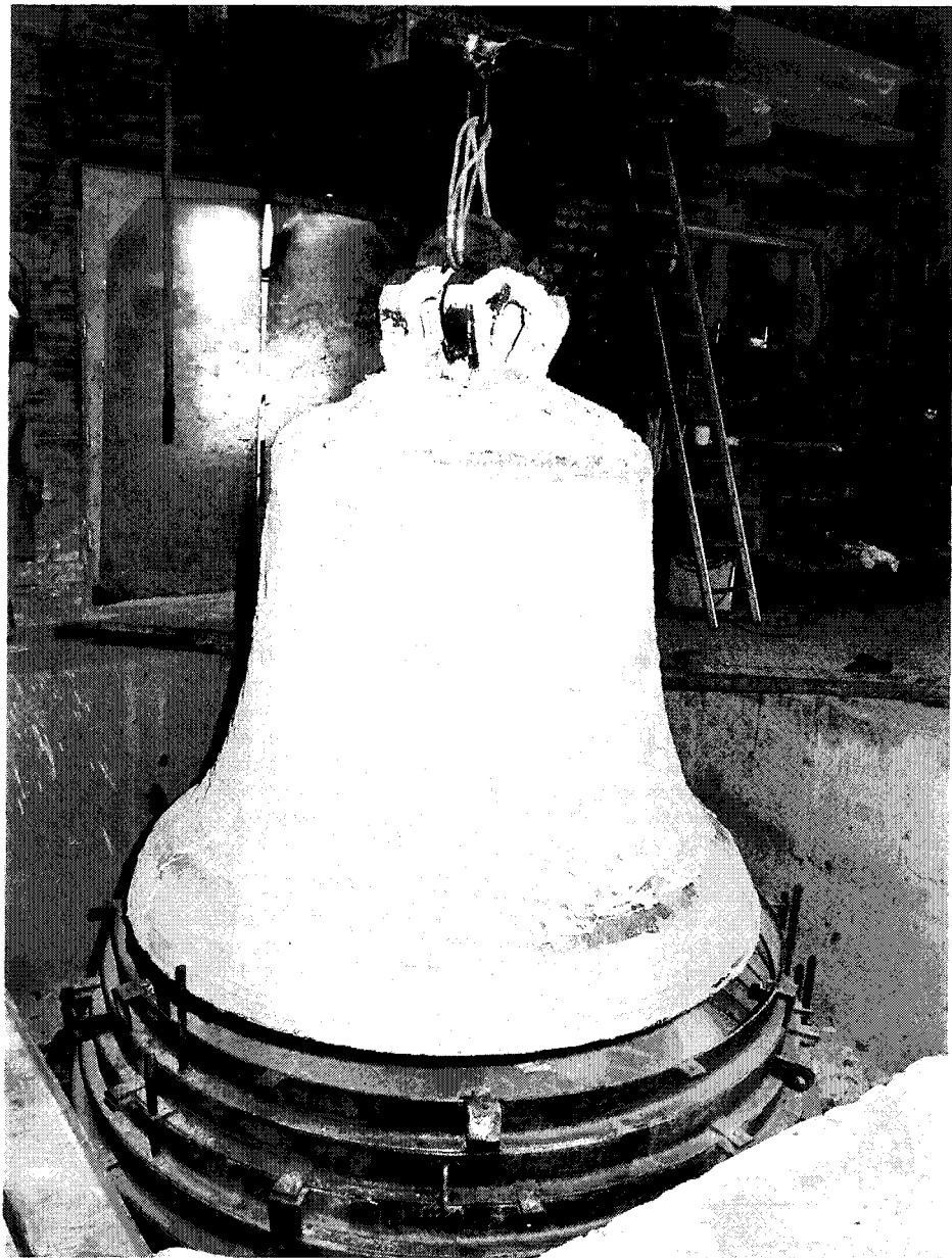
Afb. 352: Als de klok is gegoten en afgekoeld en mantel en kern vervolgens verwijderd zijn, kleeft aan de gegoten klok nog allerlei vormmateriaal dat nog verwijderd moet worden (foto Eijsbouts Asten)
