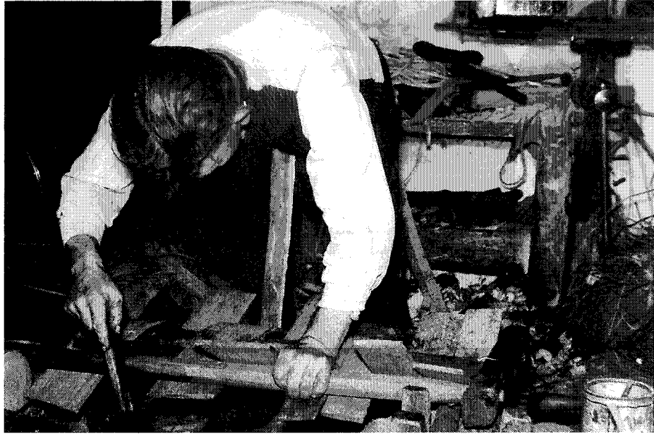
Afb. 176: Stoeldraaier Van der Pas uit Heeswijk klopt met een timmermanshamer de gebogen stoelscheien op hun juiste plaats in het scheiraam (zie ook afb. 175), waarbij hij met behulp van een plank (zie het lemma „wringknuppel”) met zijn lichaam druk uitoefent op de andere kant van het werkstuk (foto bij scriptie Donkers)
