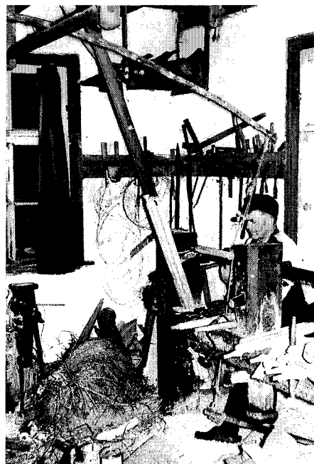
Afb. 170: De „wip”-constructie met staak (zie afb. 163, type A 5) van de primitieve houtdraaibank van stoeldraaier Van der Pas uit Heeswijk is op deze foto (uit scriptie Donkers) duidelijk te zien
