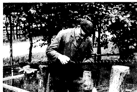
Afb. 50: Vijlen van de zaagtanden van een kraanzaag (links het afneembare, gedraaide, houten handvat van de zaag; foto Openluchtmuseum Domein Bokrijk 244/5)
