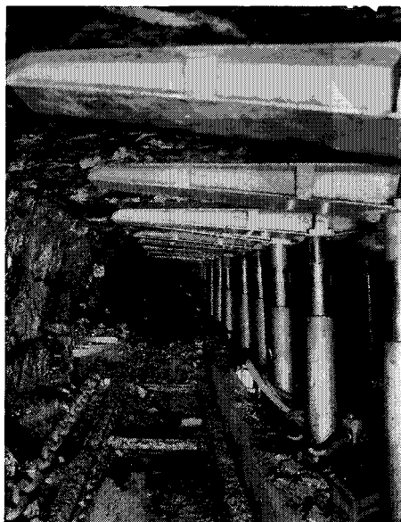
Afb. 57. mechanische pijler met koolploeg en dubbelkettingtransporteur
