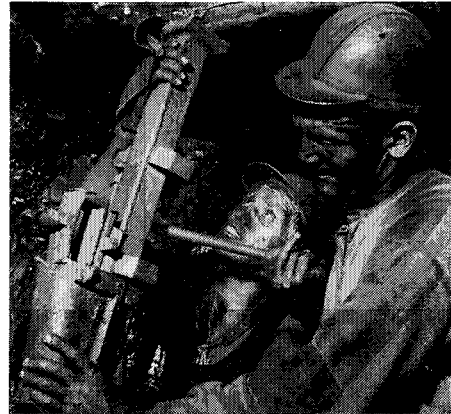
Afb. 36. schuifstijl, in dit geval een z.g. Tousseant-Heintzmann-stijl
