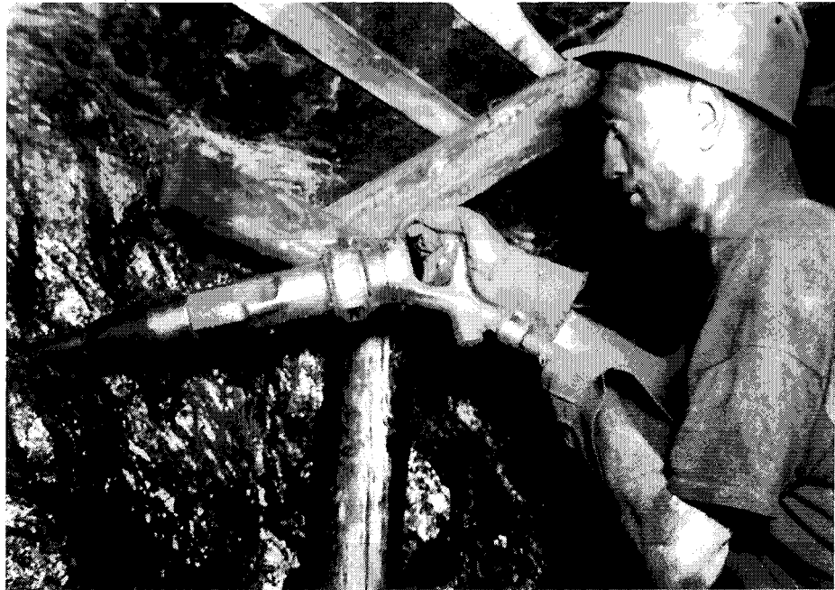
Afb. 51. kool delven met behulp van een lucht-hamer
