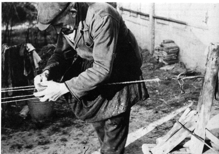
Afb. 77. het ineendraaien van strengen uit spingaren met behulp van een tol, beginnend bij de touwslagersslede met draaihaak en lameroen
