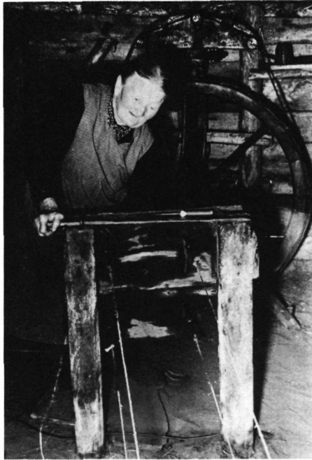
Afb. 79. soort hakenbord, rondsel; de vrouw draait aan het kleine rad om de vier spindraden tot een touw te verenigen
