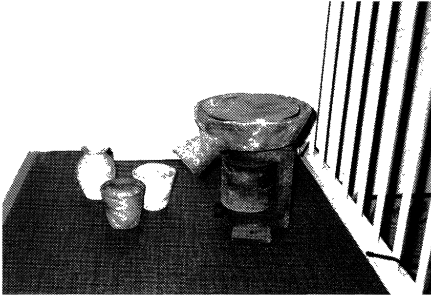
Afb. 3. elektrisch aangedreven draaischijf met links de afvoerpijp
